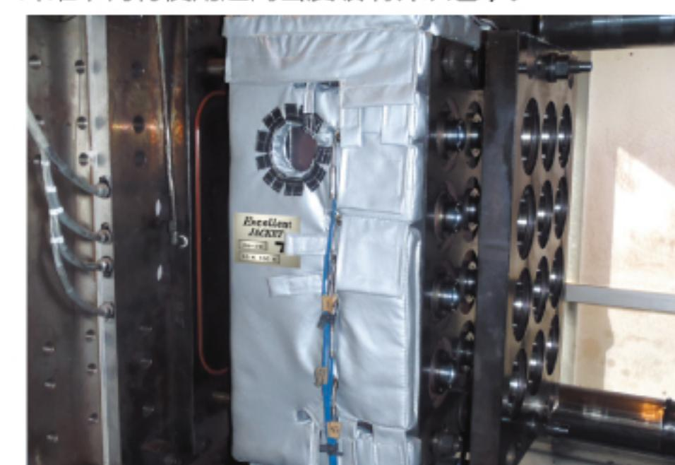
外材、内材：隔热硅胶布、硅胶布 隔热材：高密度硅胶布 缝线：不锈钢线
